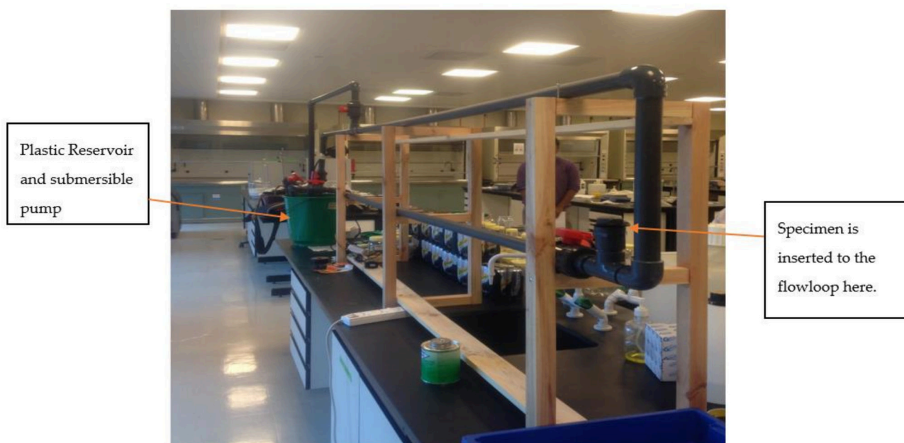
Figure 4. The actual flow loop.
